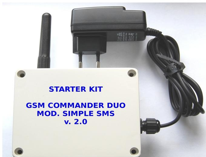
Il dispositivo è composto da un modem TC35 che utilizza la rete GSM e da un'interfaccia gestita da un microcontrollore.
