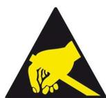
Il dispositivo è particolarmente sensibile alle correnti di tipo elettrostatico, e per tale motivo, evitare di toccare parti e componenti elettriche presenti sul circuito con le dita ove possibile.
