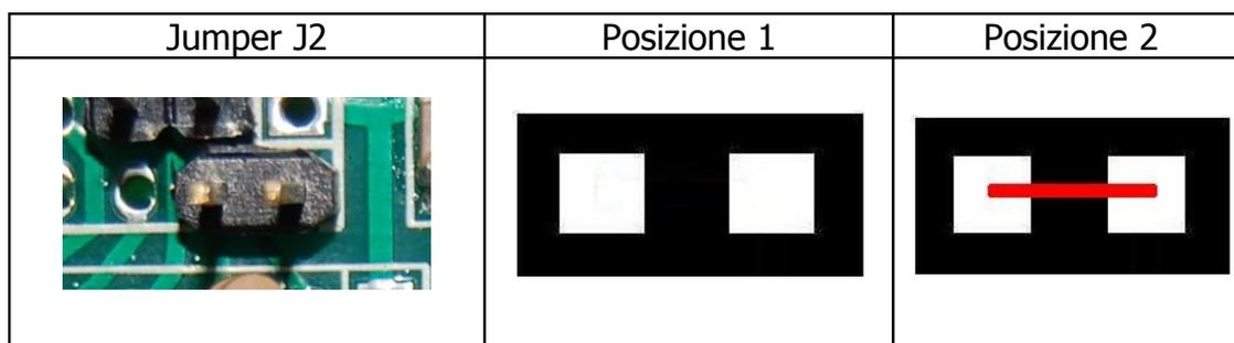
Quando il Jumper J2 è inserito in posizione 2, il dispositivo è configurato per effettuare sono chiamate vocali di emergenza. Se il Jumper è in posizione 1 ( disinserito), il dispositivo effettuerà solo SMS di emergenza.
